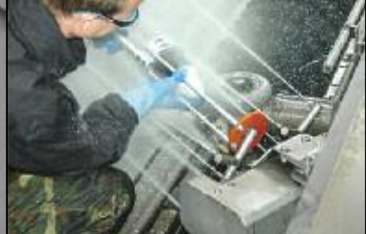
...ermöglicht die exakte Bestimmung des Wasserdrucks auf die Karosserie.
