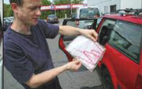
Spezielle Folien zeichnen die einwirkenden Kräfte während der Wäsche auf.
