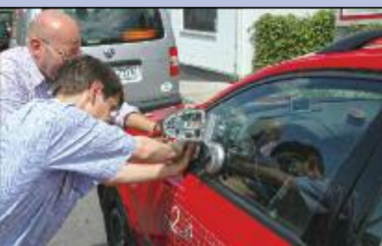
Mit Saugnäpfen lässt sich der Spiegel an der Fahrer- oder Beifahrerseite befestigen.
