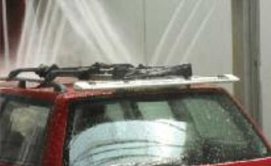
Die eigens für das VDA-Siegel entwickelte Messvorrichtung auf dem Fahrzeugdach.
