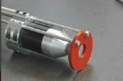
Der für die Messung des Wasserdrucks entwickelte Staudrucksensor...
