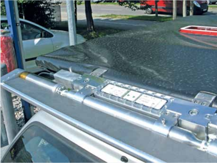
Der Spoiler auf dem Prüffahrzeug ist ein Sensor zur Messung der mechanischen Belastung während des Waschvorgangs. Die wesentliche Belastung kommt von den Horizontalbürsten der Waschanlage und wirkt in Form von Streckenlasten auf die Spoilerfläche.
