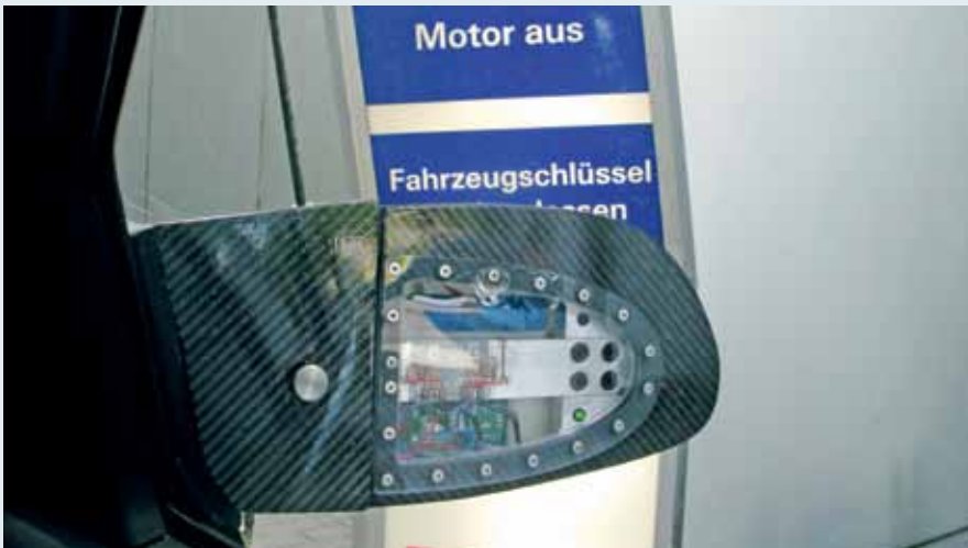
Aufgabe des Spiegelsensors ist die Messung der Belastung durch die seitlichen Waschbürsten. Über Dehnungsmessstreifen können die Querkraft und das Fußpunktmoment am Spiegel ermittelt werden.
