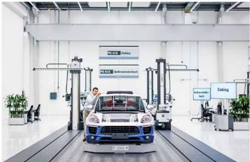
Bild 1. Im neuen Qualitäts- und Analysecenter am Standort Leipzig werden Karosseriespaltmaße am Außenmeisterbock exakt vermessen. (© Porsche AG)
