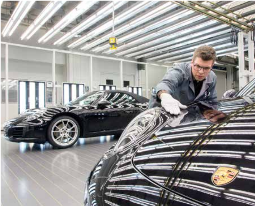
Bild 3. Jede kleinste Irritation im Lack zeigt sich dem geschulten Auge im Lichttunnel. (© Porsche AG)
