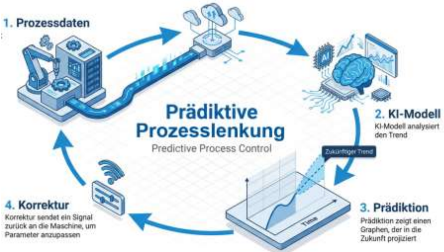
Abbildung 6-5: KI-gestützter Regelkreis zur prädiktiven Prozesslenkung
