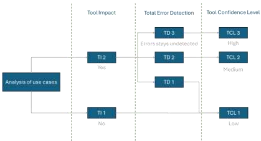
Abbildung 7-12: Ableitung des Tool Confidence Level (TCL)
